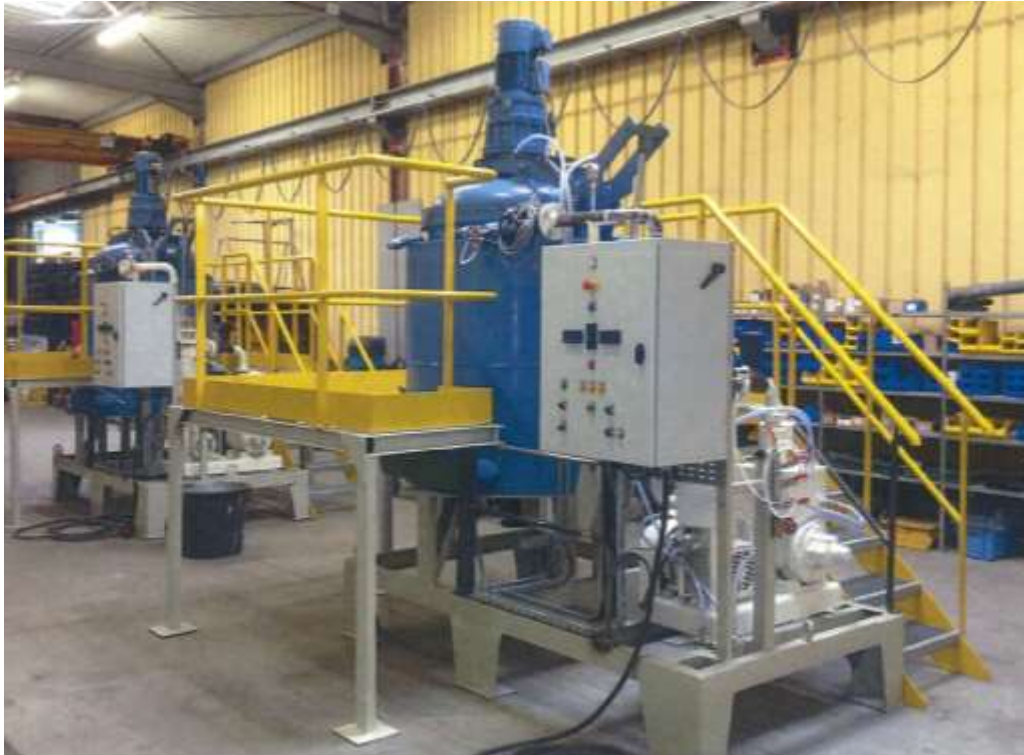
Figure 9 : Photographies des deux malaxeurs équipés de leur passerelle
